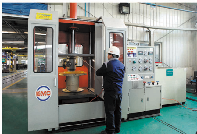
立式打压机（气压检测）
