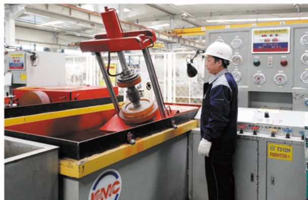
潜水式阀门检测机 (水压检测、气压检测)
