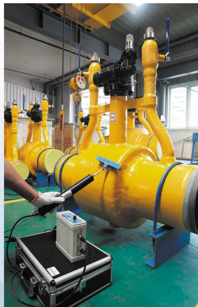
防腐电火花检测
