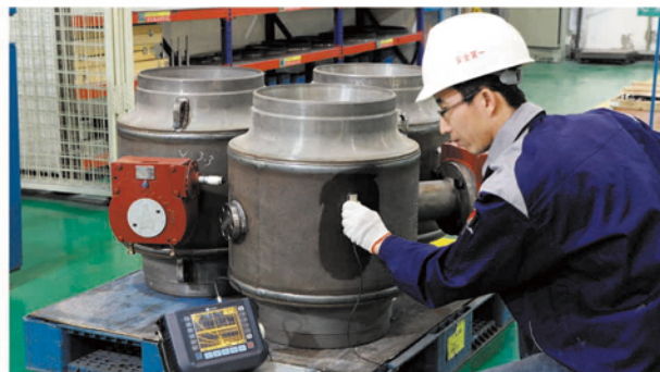
UT检测 (焊接处内部探伤检测)
