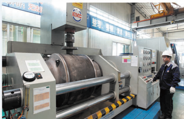
顶压式液压阀门测试机 (阀门扭矩、水压检测、气压检测)
