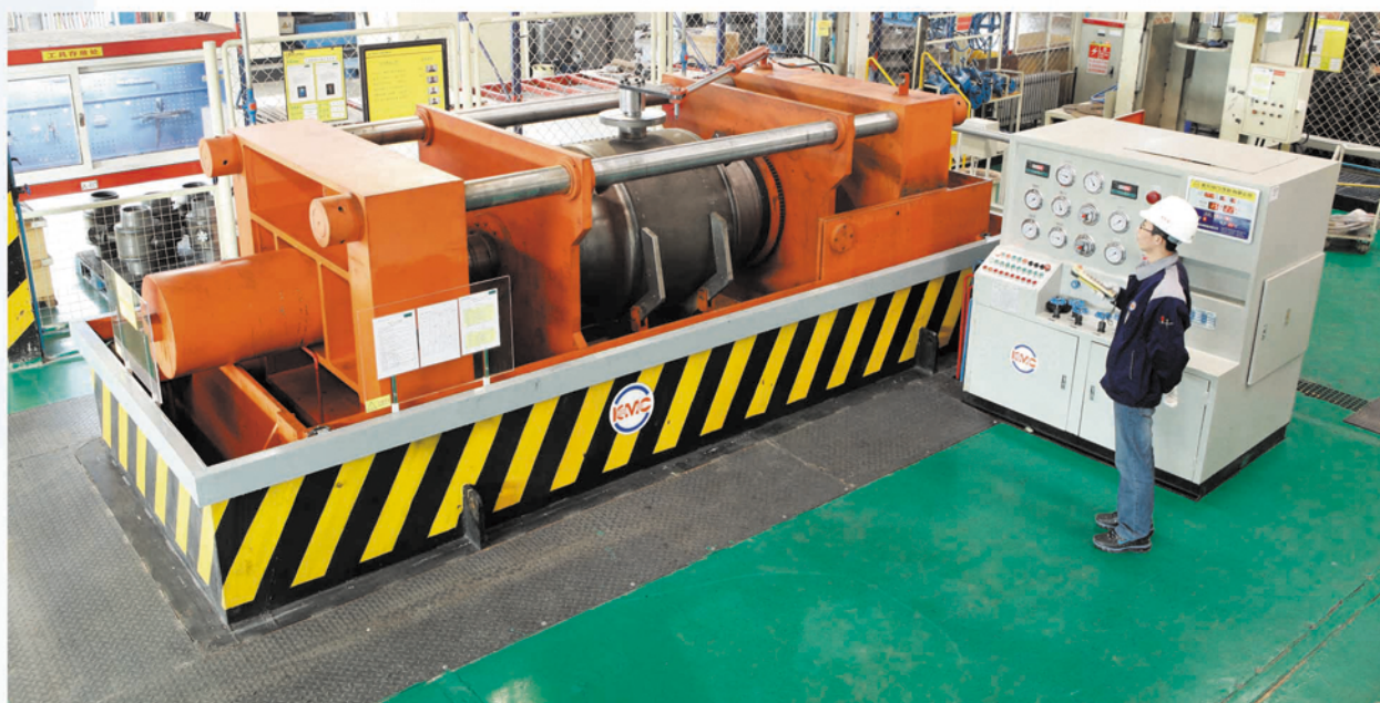
大型多功能潜水式打压机 (水压检测、气压检测)
