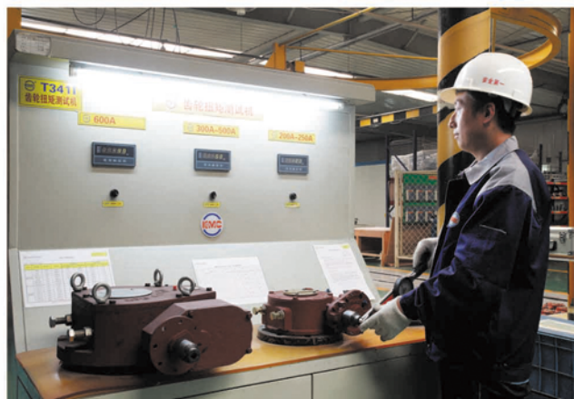
齿轮扭矩检测（检测齿轮扭矩是否与阀门扭矩相符）
